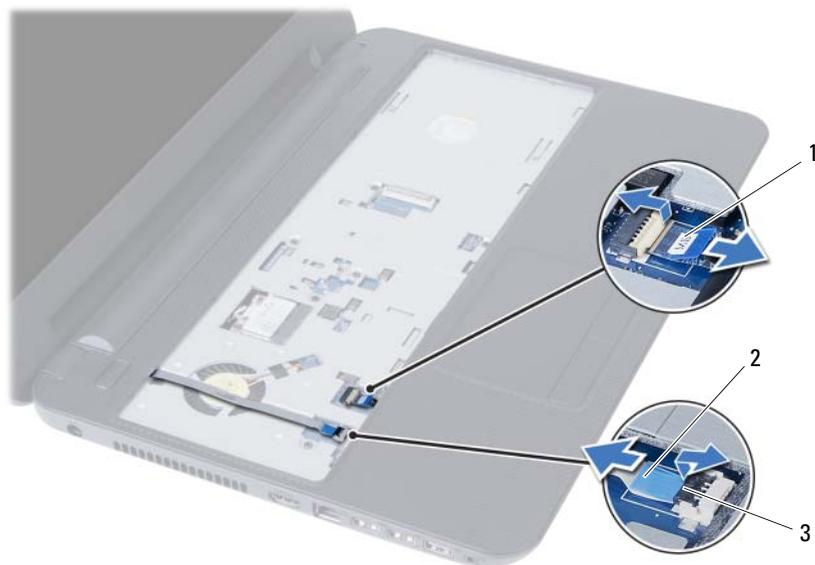
1 kabel sledilne ploščice
